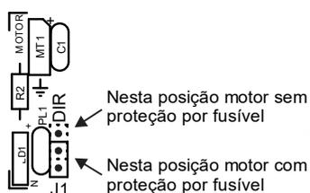
Obs: Sem o jumper o motor funciona com proteção por fusível
