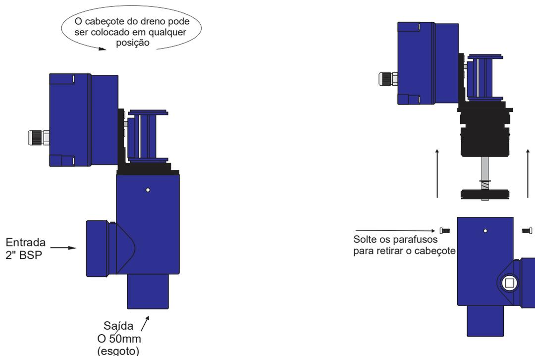
Obs: Dentro da caixa de ligações do dreno, tem um led vermelho, se o dreno for acionado e este led acender, significa que o dreno está bloqueado ou travado e será preciso providenciar a sua limpeza e desbloqueio.
